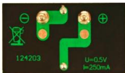
Zonnepaneel 0,5 V en 250 mA
